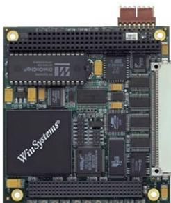
Figura 1 - Exemplo de uma board PC-104
